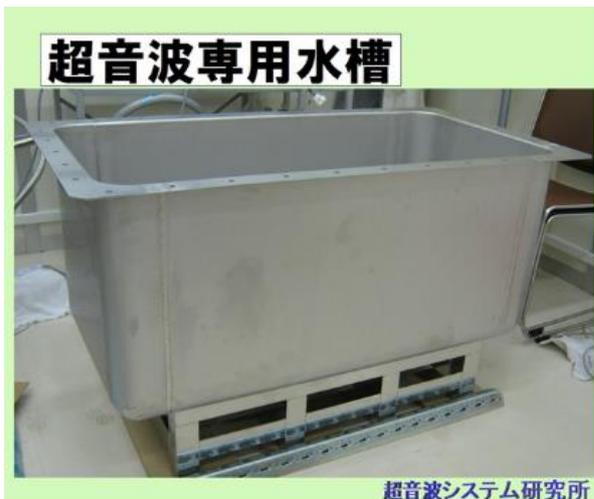
写真9 超音波専用水槽
