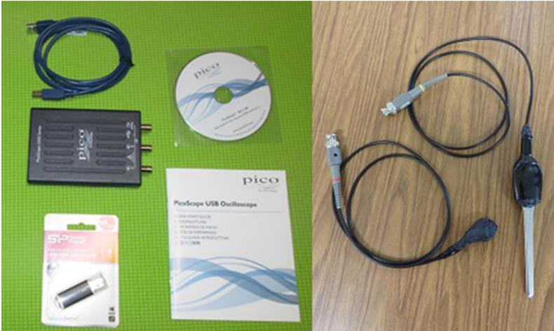
写真6 超音波計測装置（超音波テスター）
